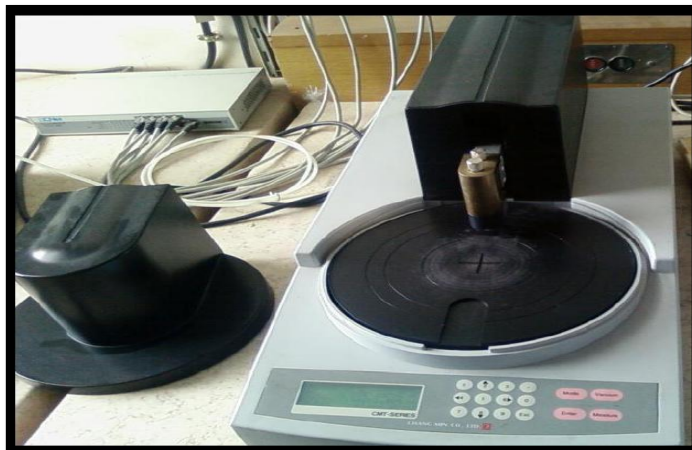
Figure 41 : résistivimètre CMT-SR 2000N.
