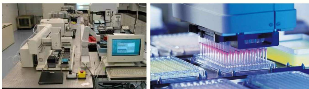
Figure 2 : Aperçu d'une plateforme de HTS robotisée et une plaque 96 puits
