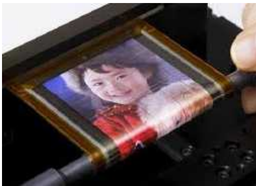
Figure.11. Ecran polychrome tout polymère à base d'OLED.
