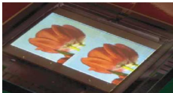
Figure 3. Ecran polychrome tout polymère à base d'OLED
