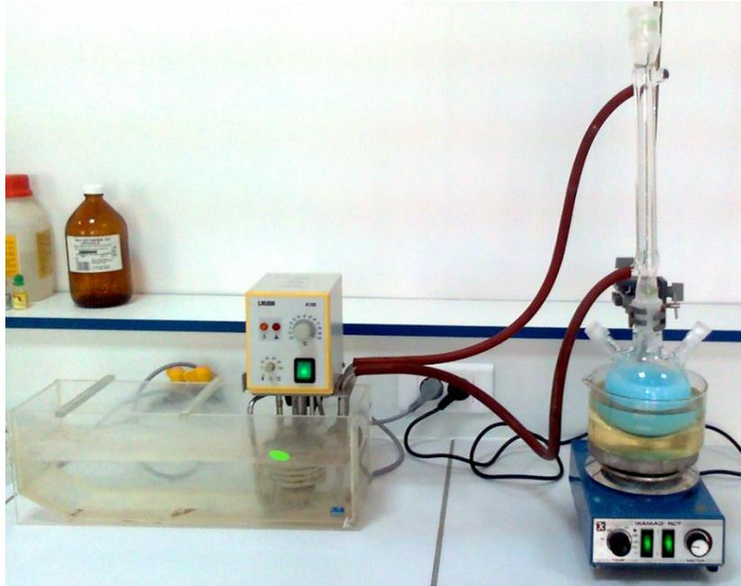
**Figure III-6 :** Montage avec reflux pour la synthèse des HDLs Mg-Al-Cu CO<sub>3</sub>.
