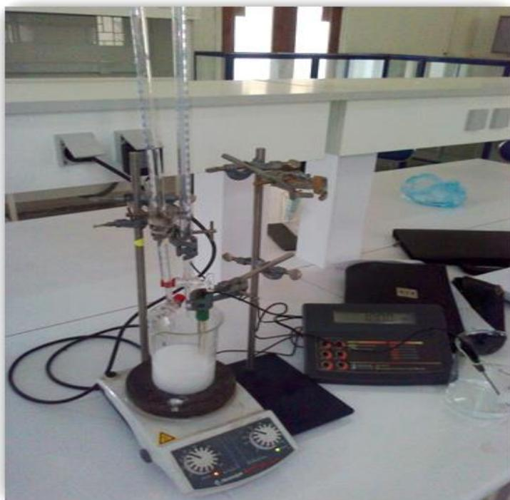
**Figure III-1 :** Dispositif de synthèse de l'hydrotalcite Mg-Al-CO<sub>3</sub>.
