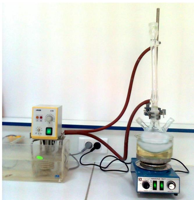
**Figure III-4 :** Montage avec reflux pour la synthèse de l'HDL Mg-Al-CO<sub>3</sub>.
