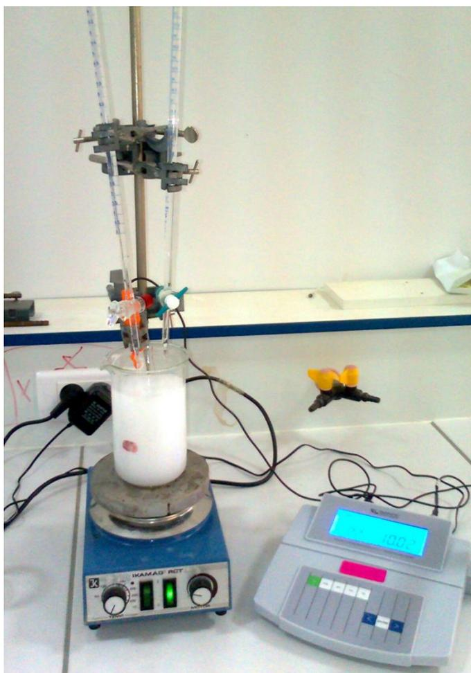
**Figure III-2 :** Montage sans reflux du mélange des réactifs pour la synthèse de l'HDL Mg-Al-CO<sub>3</sub>.
