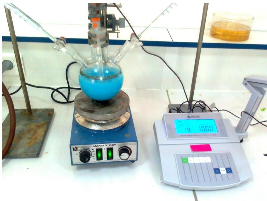
**Figure III-5** : Montage de synthèse des HDLs Mg-Al-Cu- $CO_3$ .
