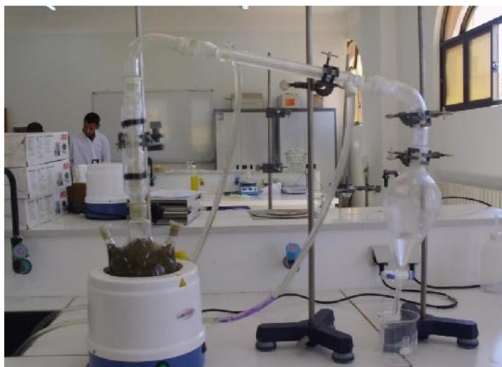
**Figure II.1 : Montage d'hydro-distillation**
