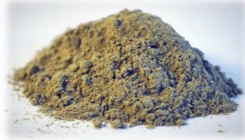
Figure II.1 : L'argile (type Montmorillonite)
