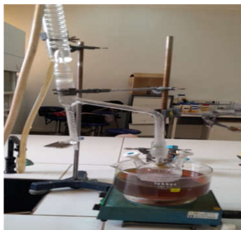
Figure II.9 : montage expérimentale de la synthèse du polymère O-AF 2 .
