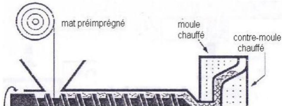
Figure 27 : Principe du moulage par injection.
