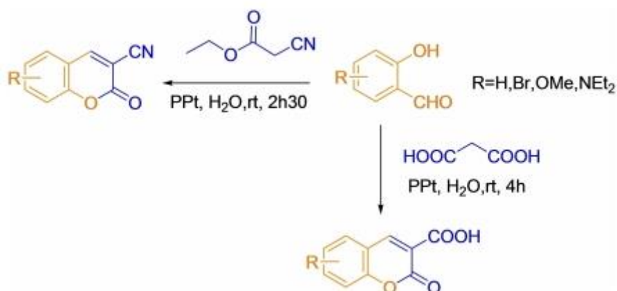
Schéma. I.8. Réaction de condensation de coumarines substituées en position 3 catalysée par le phtalimide de potassium PPt.
