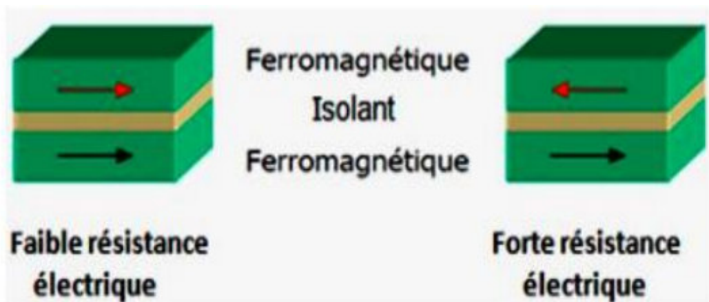
Figure.I.6. Les deux états, parallèle et antiparallèle, dans une jonction tunnel magnétique
