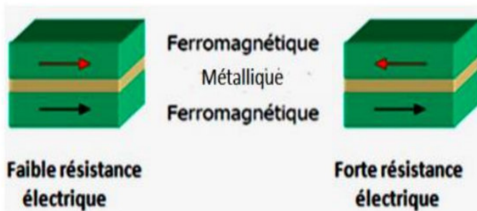
Fig. 1.5. Les deux états, parallèle et antiparallèle, dans une jonction géante magnétique.
