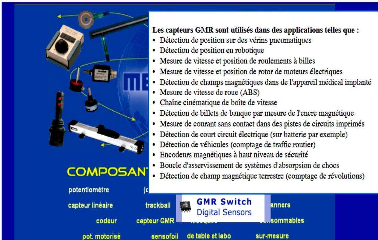
Figure 9 Capteurs spintroniques
