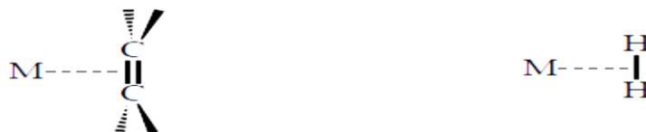
Figure 18 : Les ligands L (les deux électrons apportés caractérisent une liaison entre deux atomes du ligand L).
