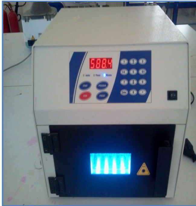
Figure III-14 : photoréacteur statique (BLX-E 365).
