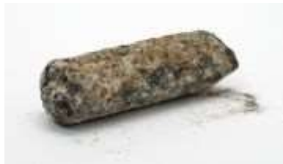
Figure I.3. Thallium métallique corrodé [4].
