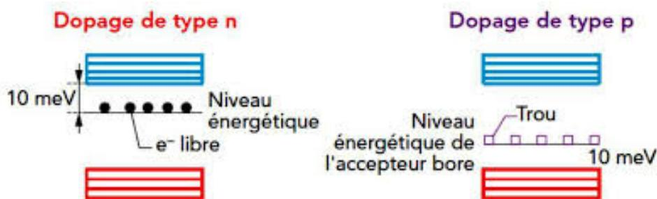
FIGURE 1.4 – La structure de bandes des semiconducteurs type n et p.
