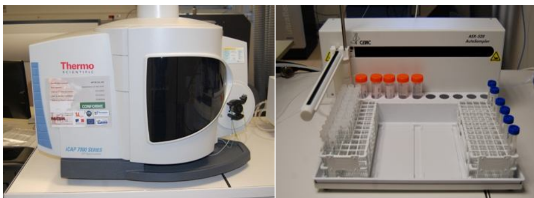
Fig II. 7 (a et b). Double visée (axiale et radiale) Kit d'introduction téflon pour l'analyse de solutions à base d'HF.
