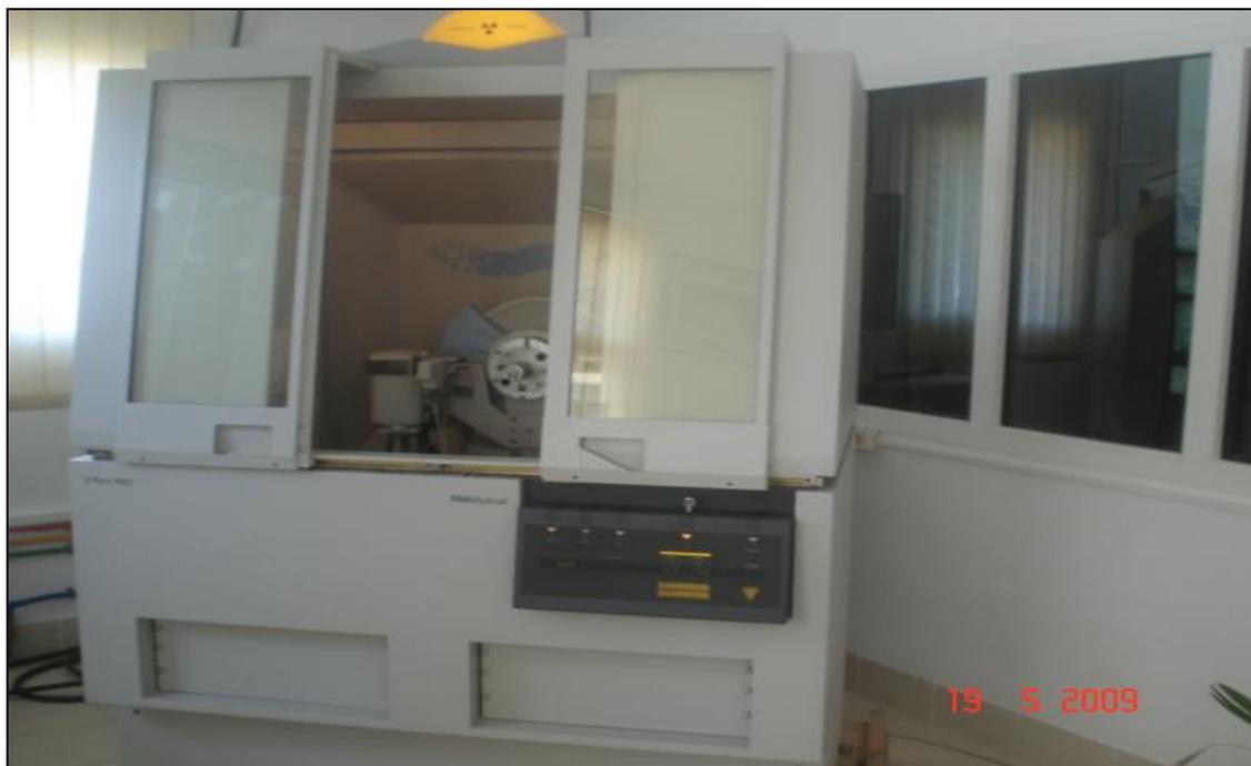
**Figure. III .4:** Appareil de Diffraction des Rayons X. modèle X'PERT Pro Philips Analytical
