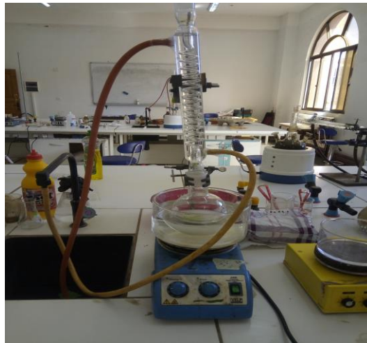
Figure IV.9 : Montage de la réaction de modification l'argile par le chitosane
