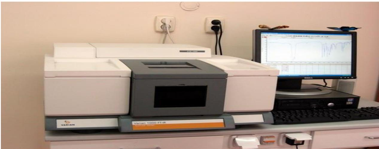
**Figure IV.4.** Spectromètre infrarouge (IR)
