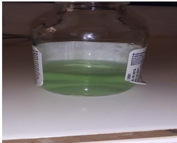
Figure IV.8 : Représenté le Gel de Silice qui Obtenue après la Séparation de Mélange (Surnagent).
