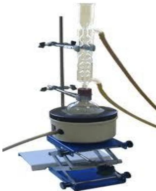
**Figure. III-2** : Montage avec reflux pour la synthèse.
