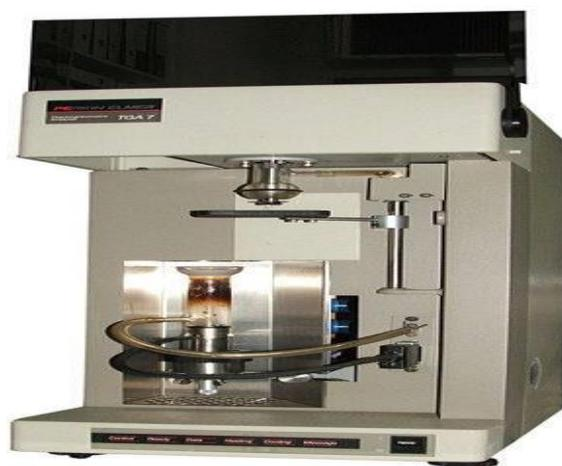
**Figure. II.10.**appareil d'analyse ATG
