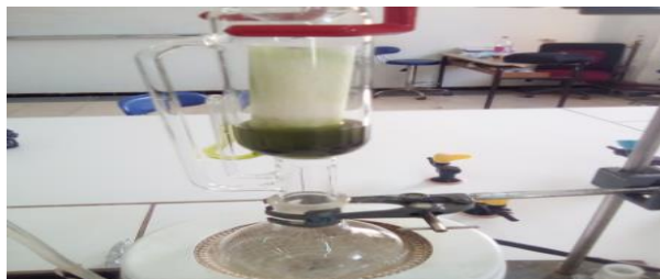
Figure II.7 : Photo de montage d'extraction avec Soxhlet
